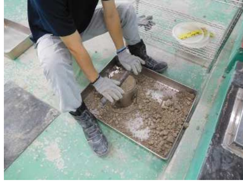
写真-2 路盤材の締固め試験
