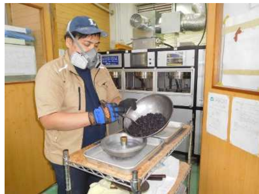
写真-6 アスファルト抽出試験
